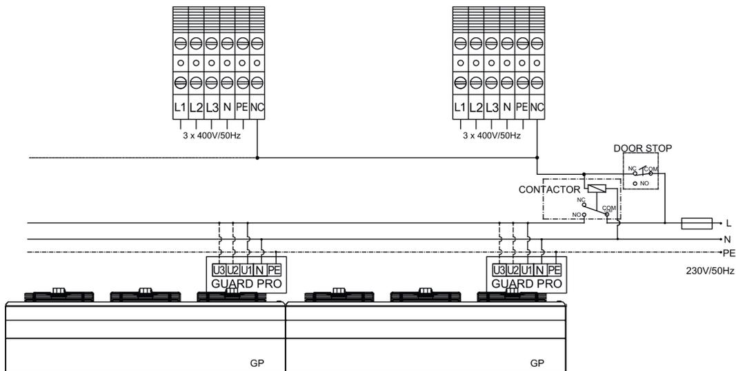
**7.5. СХЕМА ПОДКЛЮЧЕНИЯ ЗАВЕСЫ GUARD PRO W (С ВОДЯНЫМ НАГРЕВОМ), PRO C (БЕЗ НАГРЕВА) ПРИ ИСПОЛЬЗОВАНИИ РАЗДЕЛИТЕЛЬНОГО ШКАФА УПРАВЛЕНИЯ MULT16 (ПОЗВОЛЯЕТ ПОДКЛЮЧИТЬ ДО 6 ВОЗДУШНЫХ ЗАВЕС)**
