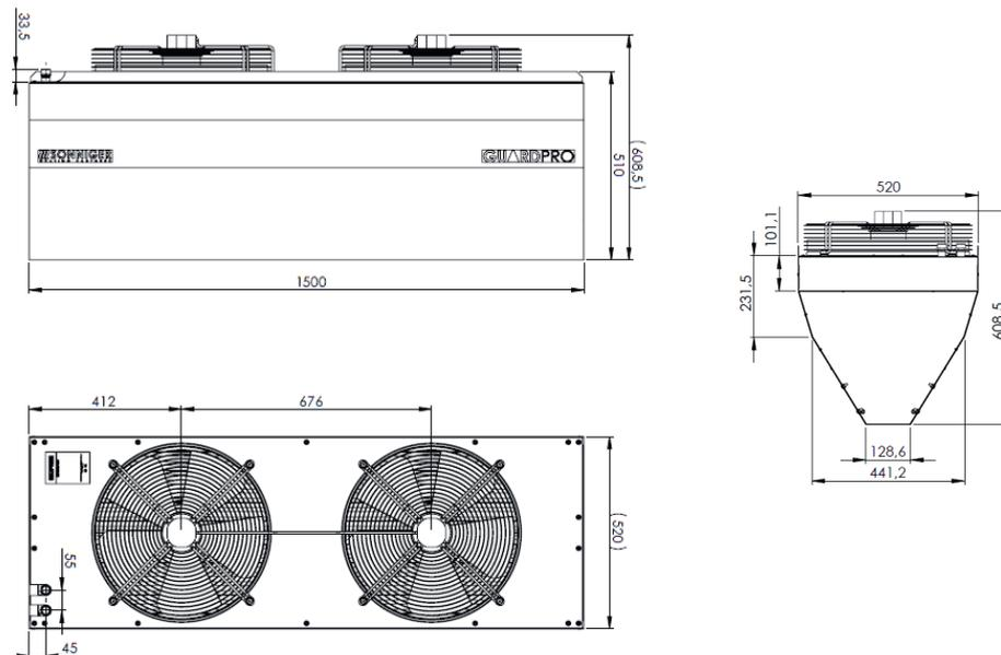
**ГАБАРИТНЫЕ РАЗМЕРЫ ПРОМЫШЛЕННЫХ ВОЗДУШНЫХ ЗАВЕС GUARD PRO 200W, 200E 200C**
