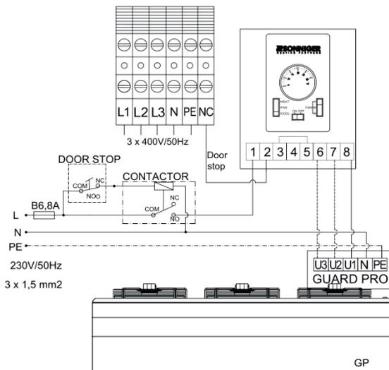
**7.3. СХЕМА ПОДКЛЮЧЕНИЯ ВОЗДУШНОЙ ЗАВЕСЫ GUARD PRO W (С ВОДЯНЫМ НАГРЕВОМ), PRO C (БЕЗ НАГРЕВА) С ИСПОЛЬЗОВАНИЕМ ШКАФА ПИТАНИЯ И УПРАВЛЕНИЯ, СТОРОННЕГО ИЗГОТОВЛЕНИЯ**
