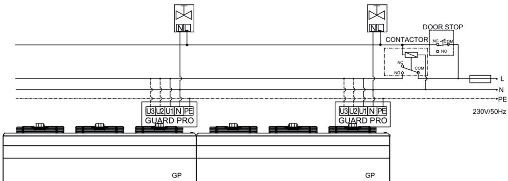
**7.4. СХЕМА ПОДКЛЮЧЕНИЯ ВОЗДУШНОЙ ЗАВЕСЫ GUARD PRO E (С ЭЛЕКТРИЧЕСКИМ НАГРЕВОМ) С ИСПОЛЬЗОВАНИЕМ ШКАФА ПИТАНИЯ И УПРАВЛЕНИЯ, СТОРОННЕГО ИЗГОТОВЛЕНИЯ**
