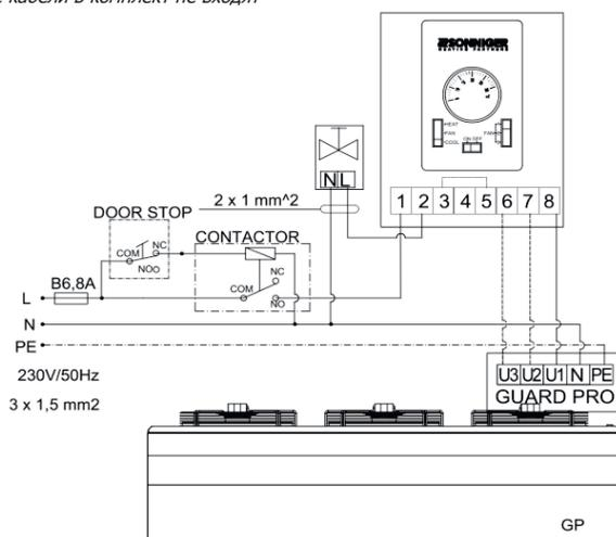
**7.2. СХЕМА ПОДКЛЮЧЕНИЯ ЗАВЕСЫ GUARD PRO E (С ЭЛЕКТРИЧЕСКИМ НАГРЕВОМ) ПРИ ИСПОЛЬЗОВАНИИ ПАНЕЛИ УПРАВЛЕНИЯ COMFORT**
