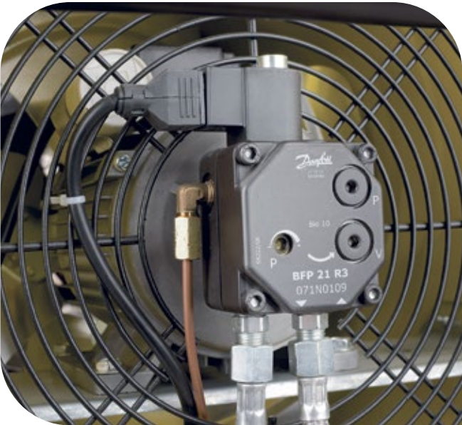
Насосная система питания (модели BHDN-30/50/80)
